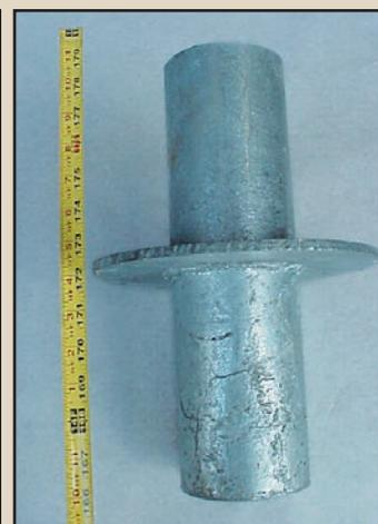
Figura 2: Camisa de pared galvanizada enviada para prueba
