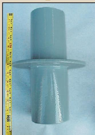
Figura 1: Revestimiento de pared Gal-vo-plast® presentado para prueba
