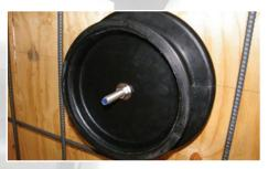
3. Inserta la segunda tapa, coloca una rondana y una tuerca para sostenerlas. Revisa que todo quede escuadrado en todas direcciones con el molde.
