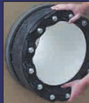
3. Faites glisser l'ensemble Innerlynx® dans l'espace annulaire. Une lubrification avec une fine solution d'eau savonneuse peut aider si elle est bien serrée.
