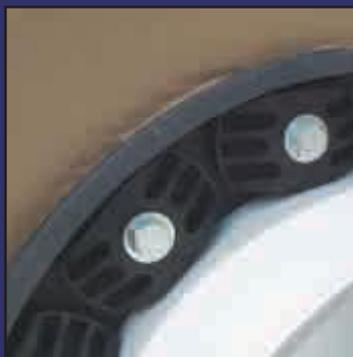
7. Répétez le processus jusqu'à ce que le caoutchouc commence à se gonfler légèrement et que le boulon soit serré. Faites un tour de plus sur chaque boulon autour de l'ensemble de l'assemblage.
